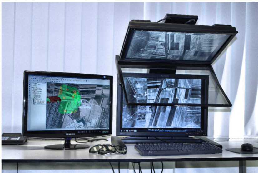
Abb. A-4-3: Arbeitsplatz zur digitalen stereoskopischen Luftbildinterpretation
