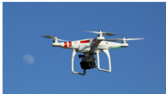
Abb. A-4-6: Mikrodrohne mit montierter HD-Kamera; Quelle: CC BY 2.0 Don McCullough from Santa Rosa, CA, USA
